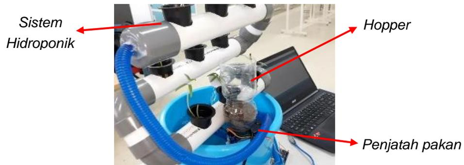
Gambar 3 Prototipe Sistem Pakan Otomatis
